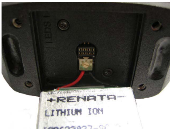
Bild 5. Potentiometern justeras endast vid behov! (Funktionen finns inte i alla modeller)
