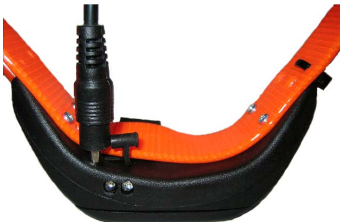
Bild 1. Batteriet laddas när den röda LED-dioden blinkar.
